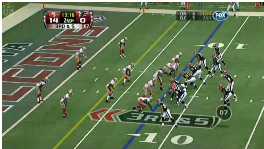
Abbildung 1: Augmented Reality bei Fernsehübertragungen. Einblendung einer First-Down-Linie (in Gelb) bei einem amerikanischen Football-Spiel (Sung 2011).
