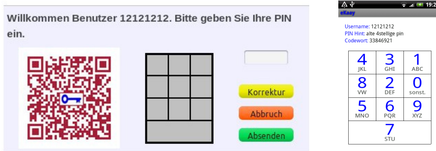
Abbildung 2: Das eKaay Login-Verfahren mit PIN-Eingabe. Links die Anzeige des Monitors mit QR-Code und ausgegrautem Tastenfeld, rechts die Permutation auf dem Smartphone (SonyMobile 2013b).
